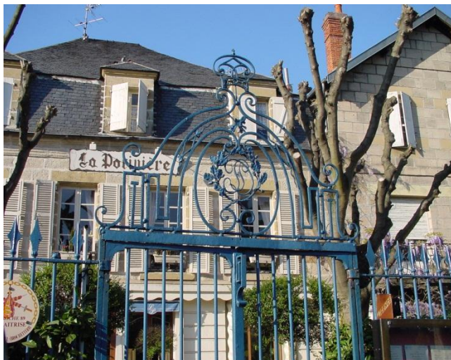
Claire voie en grille de ferronnerie à barreaux verticaux encadrés par des lisses horizontales. Ornements en ferronnerie en couronnement sur portail. Bd Maréchal Lyautey
